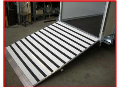
Dreh- u. klappbare Heckklappe
