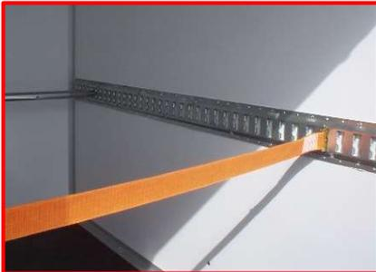
Zurrschienen im Koffer montiert
